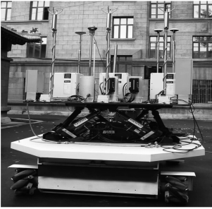
图2 船舶半实物仿真试验系统
